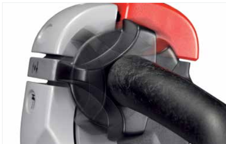
Comandi fingertip per la guida, il sollevamento e la discesa con l'esclusiva funzione Click-2-Creep
