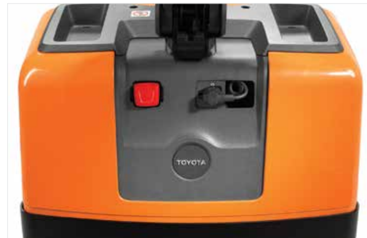
Il pannello di controllo include un cavo di alimentazione estraibile per il caricabatteria incorporato
