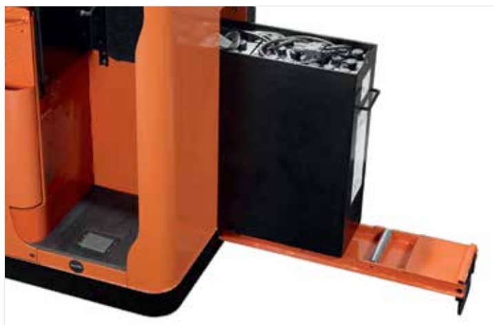
La batteria dei modelli Serie S è alloggiata su una rulliera che ne facilita l'estrazione laterale
