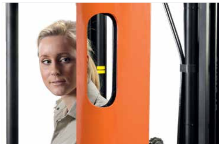
Il finestrino sul telaio posteriore aumenta gli elevati standard di sicurezza della Serie S
