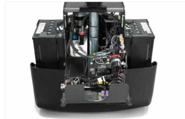
Facile accesso alla manutenzione, batterie esenti da manutenzione
