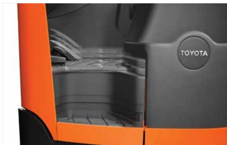
L'abitacolo operatore è regolabile per adattarsi alla corporatura del conducente. L'altezza del pavimento può essere regolata manualmente o con comando elettronico.
