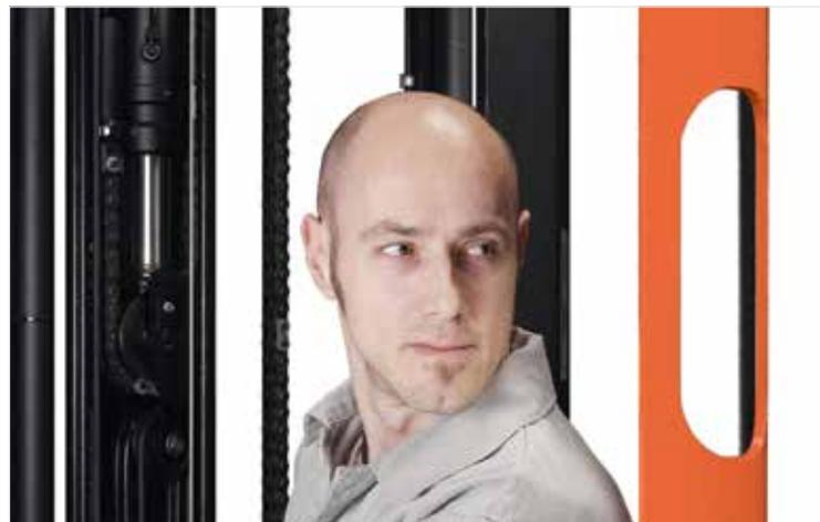
Il finestrino sul telaio posteriore migliora la visibilità ed aiuta l'operatore a guidare rimanendo all'interno della sagoma del carrello, a beneficio della sicurezza.
