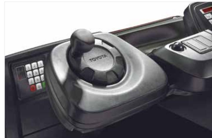
I modelli della gamma Reflex Serie N sono dotati di uno sterzo a 360° per un controllo intuitivo e reattivo
