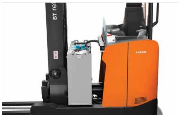
Le batterie a ioni di Litio consentono di effettuare il cambio batteria quando è più comodo e sono più efficienti del 30% rispetto alle batterie tradizionali.
