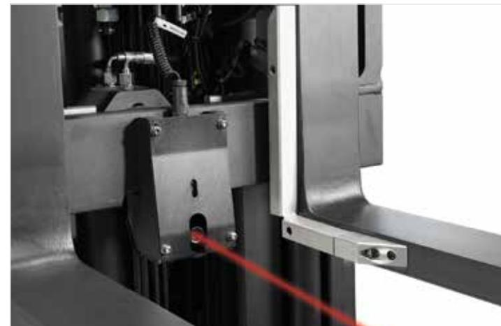
Il posizionamento delle forche davanti ai pallet, agevolato dall'opzione laser, riduce i costi dovuti ai danni e mantiene elevato il livello di produttività.
